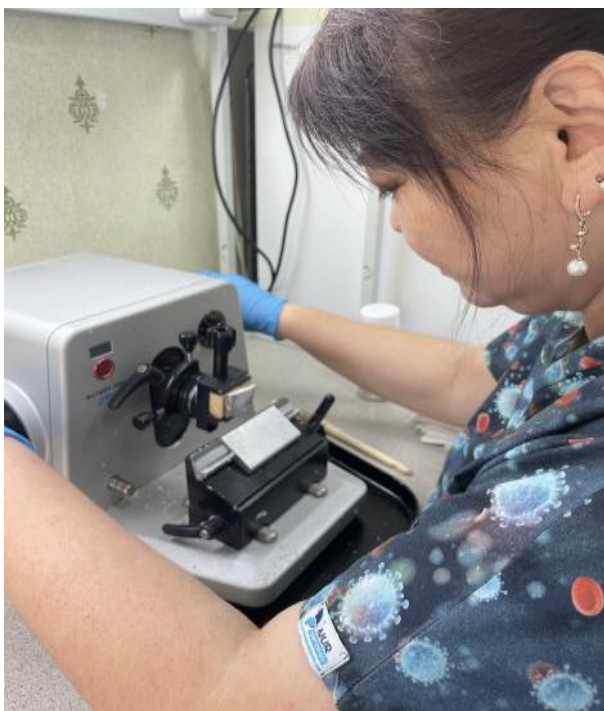
Рис. 1 - закрепление блока, извлеченного из холодильника в микротоме
