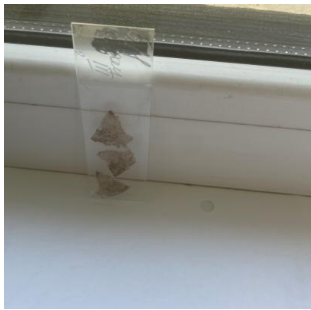
Рис. 6 - предметные стекла со срезами оставлены для стекания излишней влаги
