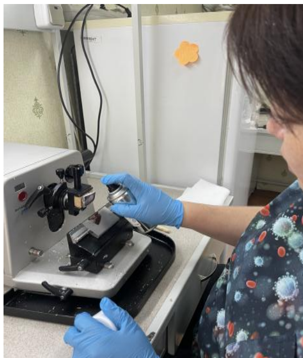
Рис. 2 - обработка блока криоспреем и вырезка срезов
