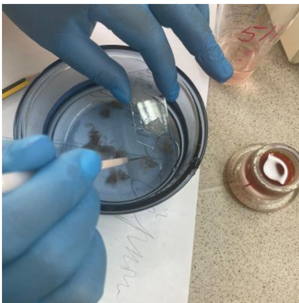
Рис. 5 - натягивание срезов из воды на предметное стекло
