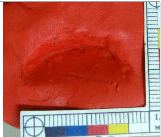
Экспериментальный след, на следовоспринимающем материале (пластилин) полученный в результате нанесения ударной части молотка
